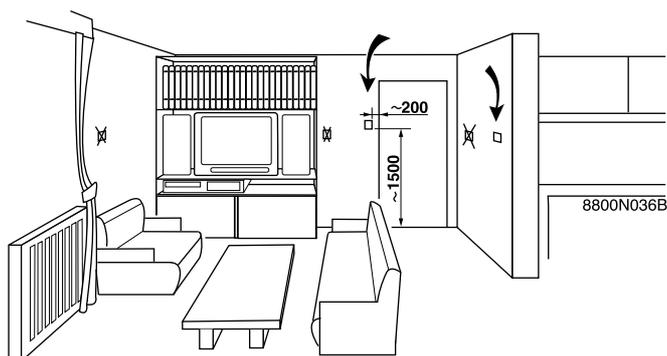
De afstandsbediening wordt tegen een binnenwand bevestigd, op ongeveer 1.5 meter van de vloer, in een verstanding gekozen kamer.
