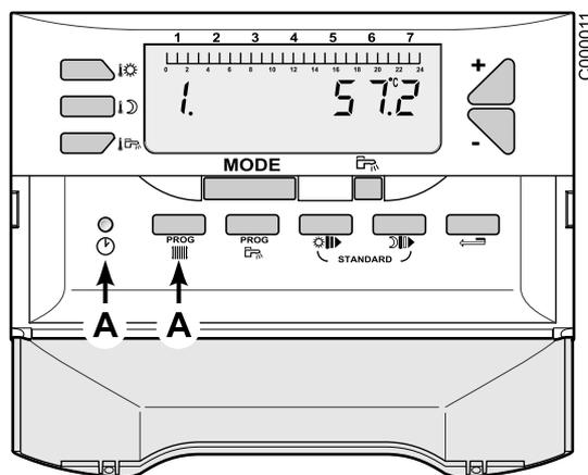
**A** = Accès au niveau installateur par appui simultané durant 5 secondes
