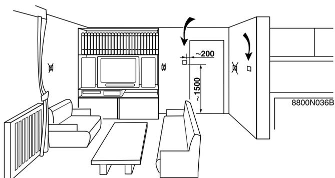
Die Fernbedienung ist an einer Innenwand in einem Bodenabstand von ungefähr 1,5 m in dem mit Umsicht ausgewählten "Bedien-Raum" anzubauen.
