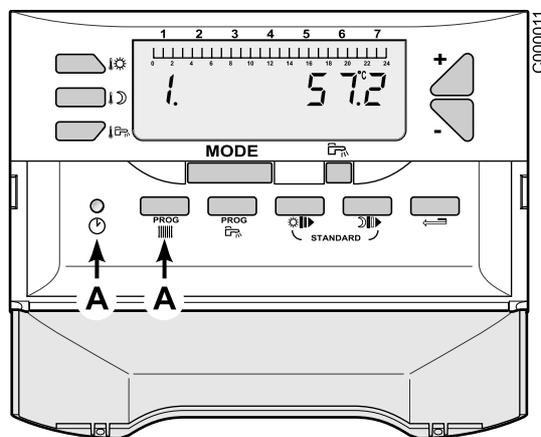
A = Zugriff auf die Installateur-Ebene durch gleichzeitige Betätigung für 5 Sekunden
